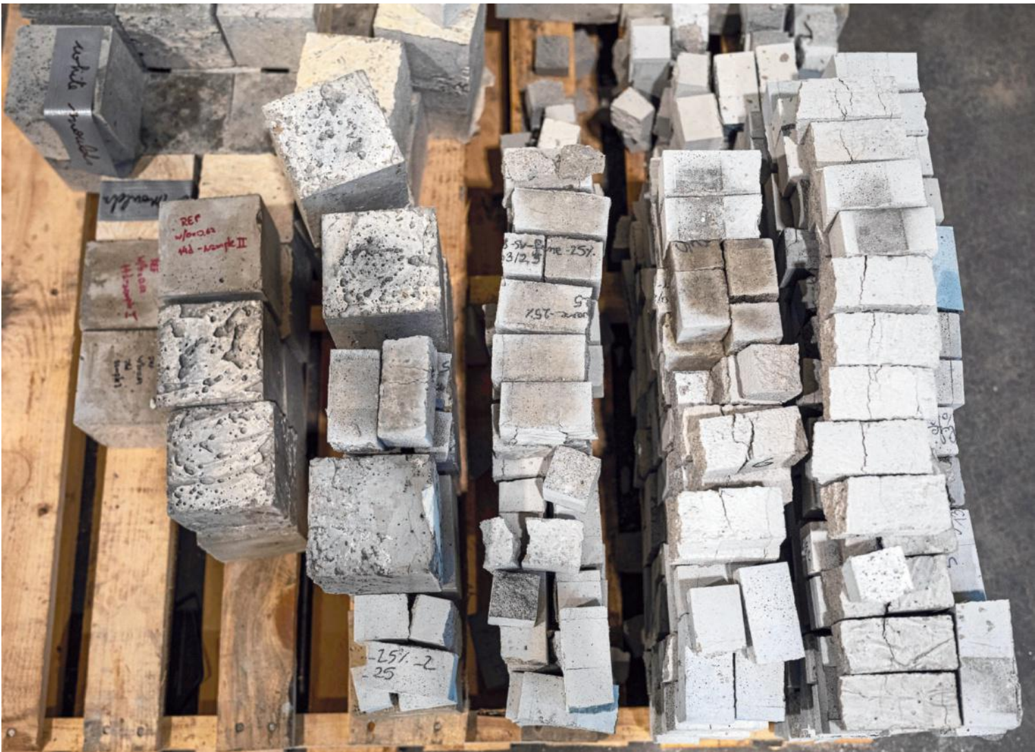
Monsters van verschillende soorten beton bij de fabriek van Paebbl. In het beton van Paebbl zit per kubieke meter 18,7 kilo CO 2 opgeslagen.
